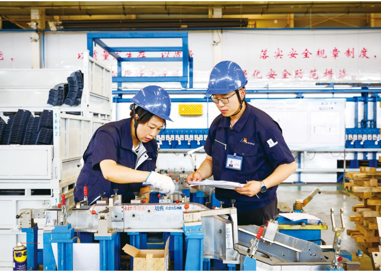
员工正在认真开展软区首件检测
